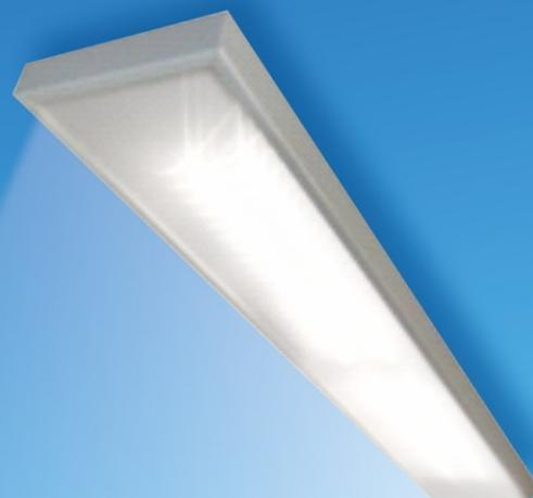
Энергосберегающий светильник ДПП 01-1x22-001-УХЛ3.1 заменяет люминесцентный светильник с 2-мя лампами по 40 Вт с улучшением качества света. Обеспечивает экономию электроэнергии около 6 раз (заменяет энергопотребление 2х ламп (по 40 Вт каждая) и дросселей (35 Вт)).
